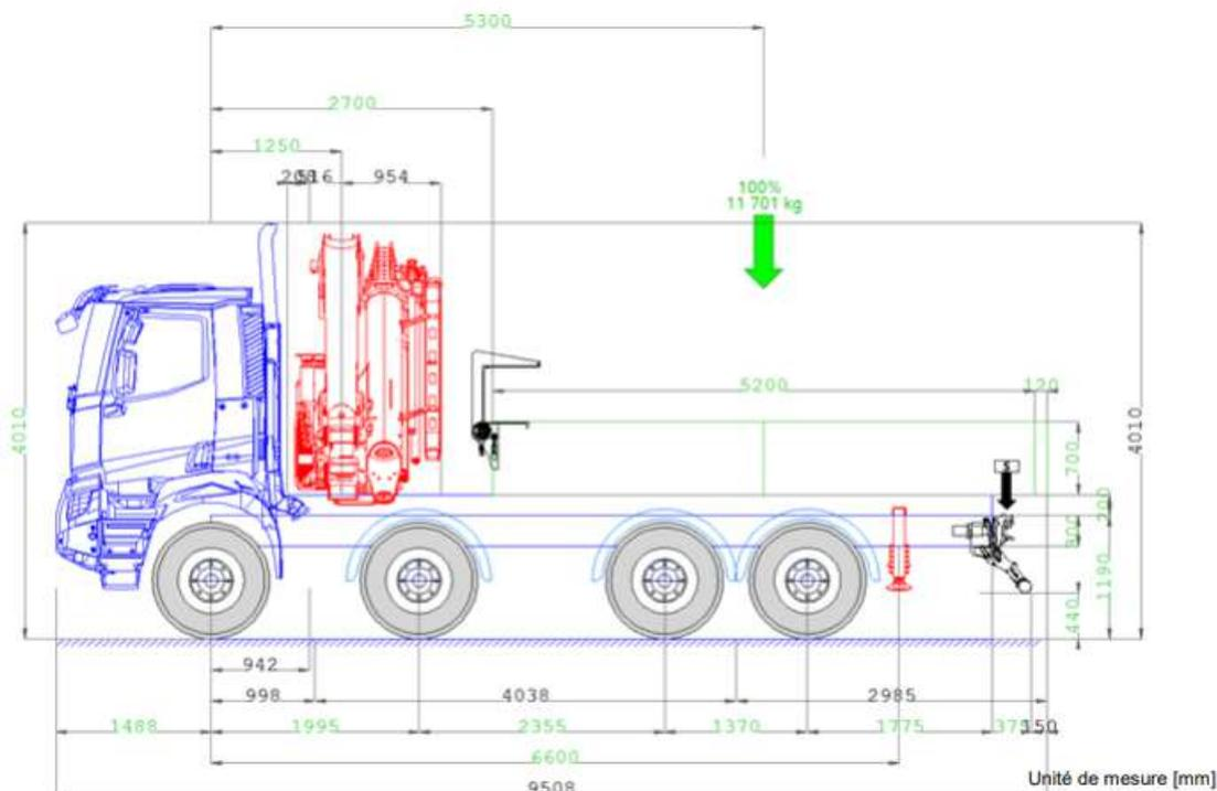
**Châssis cabine porteur remorqueur neuf RENAULT C480 P8X4, 480cv,**
